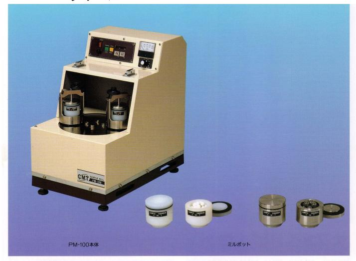
モーターよりの回転をディスクに伝達させ、ディスク上のホルダーを逆 回転させる機構となっています。この方式は、公転による絶対遠心加速 度、自転での相対遠心加速度との回転方向を互いに逆向きにすることに より、合成遠心加速度を公転速度の2乗に比例し増大させることが可能 です。機能の充実、使いやすさはもちろん、試料の粉砕、混合を効率よ く安心して任せられるよう開発されました。
